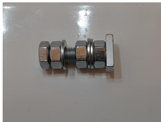
Ecco la struttura che permette di attaccare lo sportello alla cassetta
