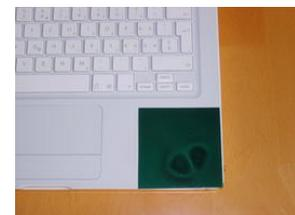
I campi magnetici si possono localizzare con un foglio di plastica rivelatore di flusso magnetico ([www.supermagnete.it/M-04](http://www.supermagnete.it/M-04)). Si possono però individuare in modo più rudimentale anche con una sfera in acciaio ([www.supermagnete.it/ST-K-13-N](http://www.supermagnete.it/ST-K-13-N)), una semplice graffetta o con un altro oggetto appropriato di uso comune.
